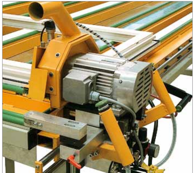
Перемещаемая пила для отрезания наплава створки (при установке штапика)
