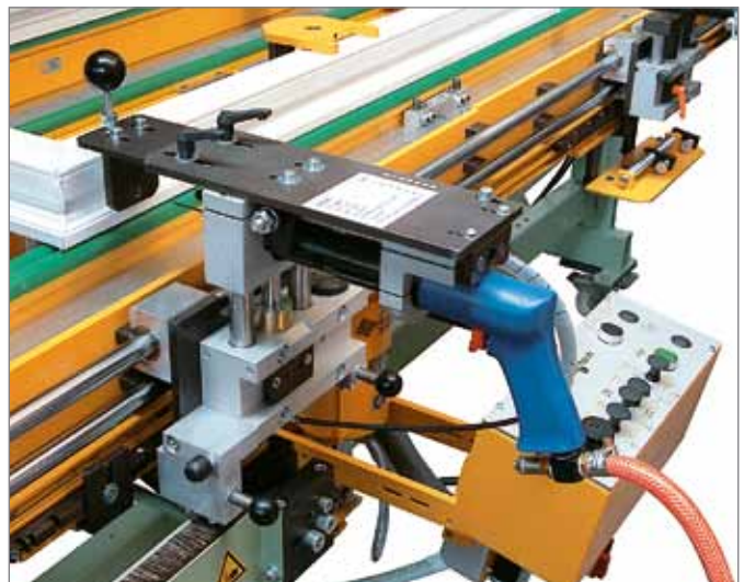
Устройство для сверления отверстий под петли
