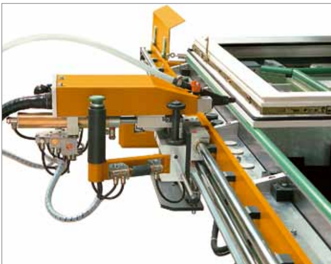
Перемещаемый шуруповёрт с автоматической подачей саморезов
