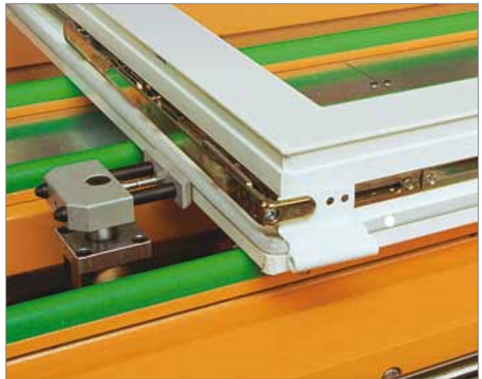
Пневматически опускаемые упоры для устройства измерения длины фурнитуры
