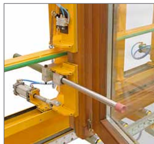
Pneumatisch ausfahrbare Versiegelungsanschlüsse, rechts und links am Pressbalken montiert.
