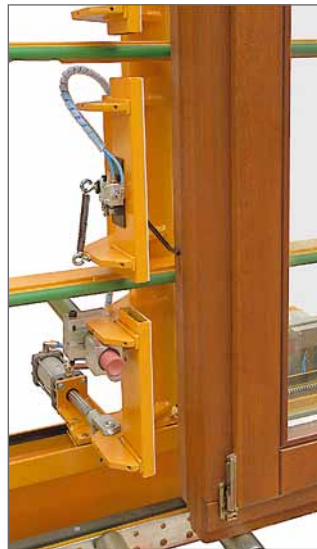
Zusätzliche Sicherheits-Endschalter, rechts und links am Pressbalken montiert; beim Betrieb mit automatischer Ablaufsteuerung.
