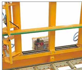
Pressbalken-Zentriergerätee oben und unten garantieren eine absolute Pressgenauigkeit.
