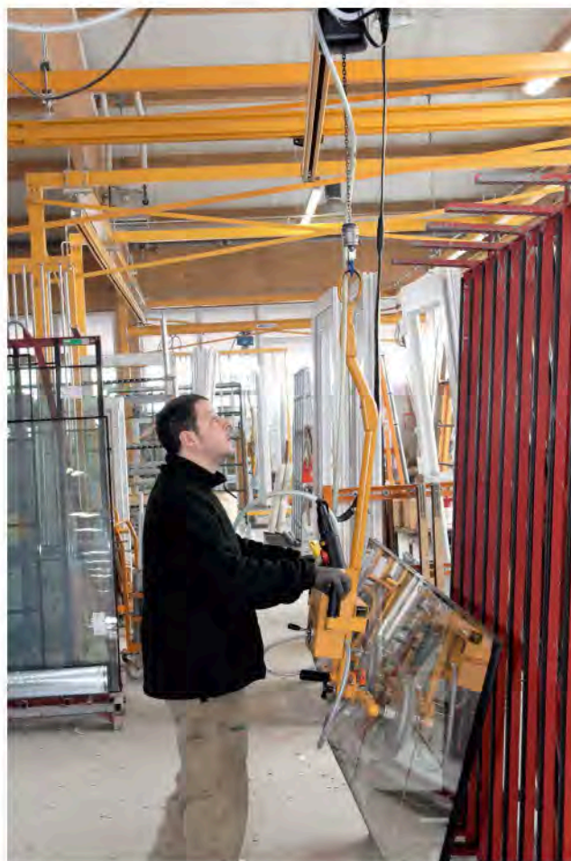
Für die Glasbereitstellung und die Verglasung stehen Zweischienenkräne inkl. Vakuum-Hebetransportgeräte zur Verfügung.
