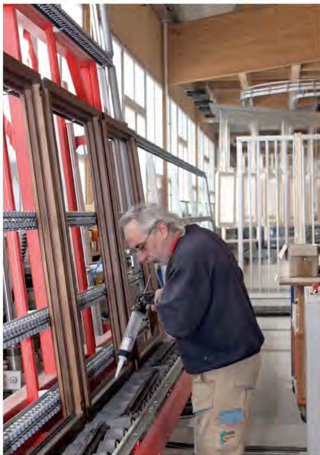
Die Montagestationen in der Holzabteilung sind wie die Verglasungs- und Versiegelungsstationen mit hydraulischer Hub- und Senkeinrichtung ausgestattet.
