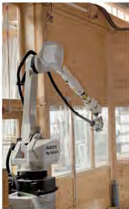
Seit letztem Jahr setzt das Unternehmen in der Oberflächenbeschichtung einen Roboter zum Auftrag der Endbeschichtung ein.
